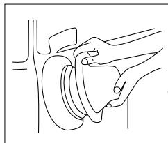
5. Затем переходить к меньшим по размерам деталям (например, двери). Кабель питания должен свисать с прибора и охватывать полировальную машину, как показано на рисунке.
