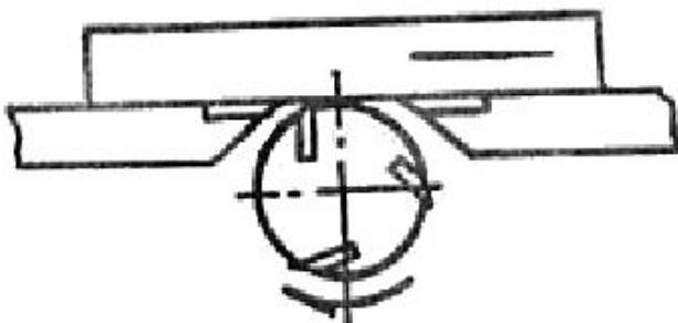
Подготовка: остановите и отсоедините станок от сети, ослабьте стопор 10 (рис.1), поверните рычаг подъема 11 для установки нужного уровня переднего стола 7, затем поверните стопор 10 для фиксации переднего стола 7. Установите строгальную направляющую горизонтально, по ширине обрабатываемой детали. Направляющая может иметь отклонение  $0\text{--}45^\circ$  от угла обработки.
