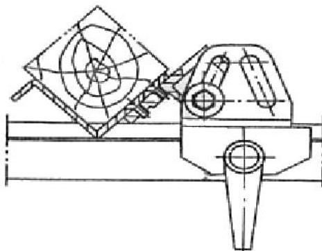
Подготовка: отключите станок и отсоедините его от сети. Установите плоскость переднего стола на высоте, требуемой для нужной глубины. Соедините линейку для снятия фасок с направляющей, а направляющую соедините с основанием (см. рис. слева). Иначе говоря, установите направляющую по правой стороне стола. Накройте лезвия кожухом.
