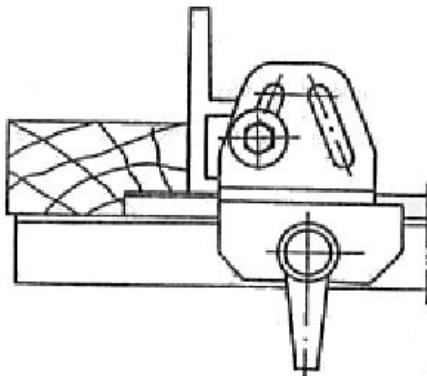
Подготовка: Отключите станок и отсоедините его от сети, демонтируйте порталный кожух. См. рис.1. Наденьте защитные перчатки, сдвиньте одно из трех лезвий или более на расстояние, требуемое для прорезки паза или на 0,5 мм. Установите плоскость переднего стола на высоте, требуемой для прорезки паза нужной глубины. Направляющая должна располагаться параллельно ходу грани.
