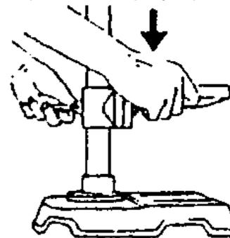
Регулировка угла наклона вертикального стола
