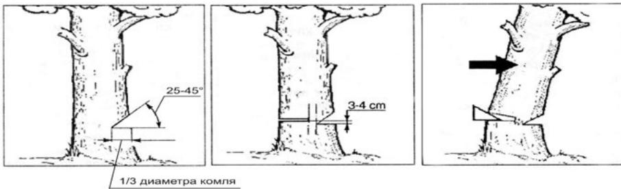
При пиления дерева с диаметром ствола более длины реза пилы применяйте ступенчатый или многосекторный пропил. Используйте зубчатый упор для поворота пилы в процессе пиления. При выполнении первого пропила место упора выберите так, чтобы конец шины при пиления вводился в ствол, оставляя в нем недопил.
